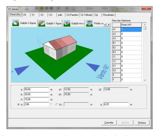
As dimensões a, b, h,  $\Theta$ , e p são destacadas no desenho clicando-se sobre o campo correspondente.
