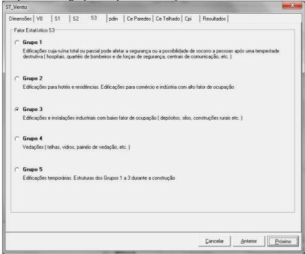
A partir da velocidade básica do vento e dos fatores S1, S2 e S3 é determinada a velocidade característica do vento  $(V_k)$  e finalmente a pressão dinâmica  $(p_{din})$ .
