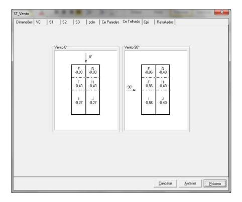
Os coeficientes de pressão interna são determinados na aba Cpi:
