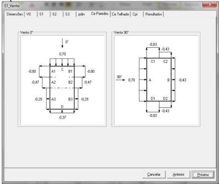
Quando a terça for de cobertura os coeficientes Ce 90° e Ce 0° serão obtidos a partir de Ce telhado:
